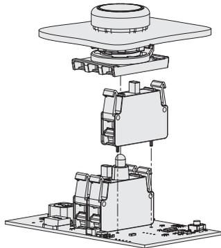
Las unidades LED de la serie EROUND para el montaje en el panel de control están disponibles como versión con pines de soldadura. Si se utiliza una placa de circuito impreso en vez de un cableado, estas unidades LED ofrecen la posibilidad de soldarse directamente.
