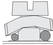
Las placas sujetacables con las que están equipados las unidades LED tienen un diseño especial (en forma de teja) y están conectadas holgadamente a los tornillos sujetacables. De este modo, al fijar los cables, la placa sujetacables se puede adaptar a los diversos diámetros de cable y aprieta los cables contra el tornillo y hace que no puedan deslizarse hacia el exterior.
